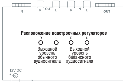
Рис. 3. Вид снизу на аудиотранскодер модели 482
