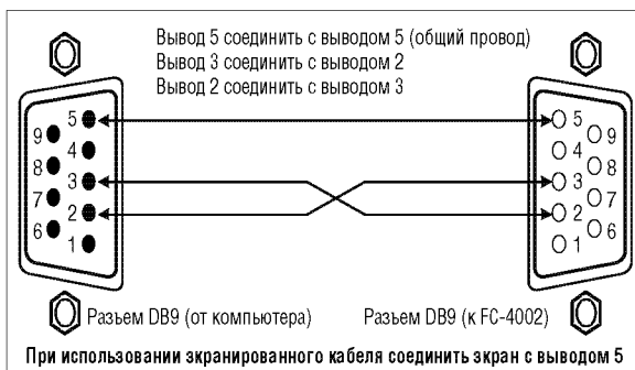
Рис. 2. Подключение компьютера без использования нуль-модемного адаптера
