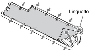
**4** Fissare nuovamente il coperchio del filtro dell'aria sull'unità.
