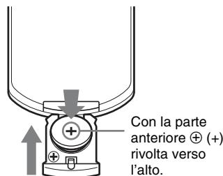
**3** Chiudere l'alloggiamento della batteria al litio.
