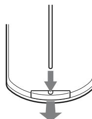
**2** Insérez une pile au lithium.
