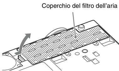
**3** Pulire il filtro dell'aria con un aspirapolvere. Tirare fuori e rimuovere il coperchio del filtro dell'aria e pulirlo con un aspirapolvere.
