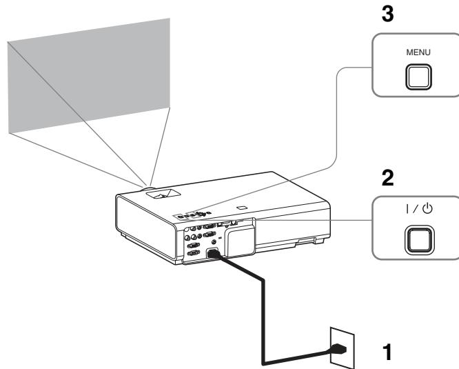
1 将交流电源线的插头插入电源插座。
