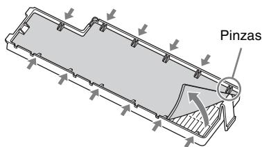
**4** Vuelva a colocar la cubierta del filtro de aire a la unidad.
