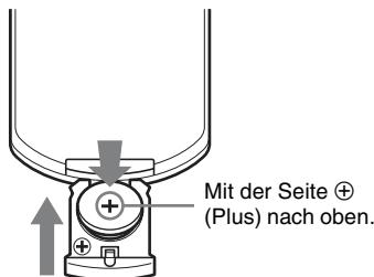
**3** Schließen Sie das Fach für die Lithium-Batterie.
